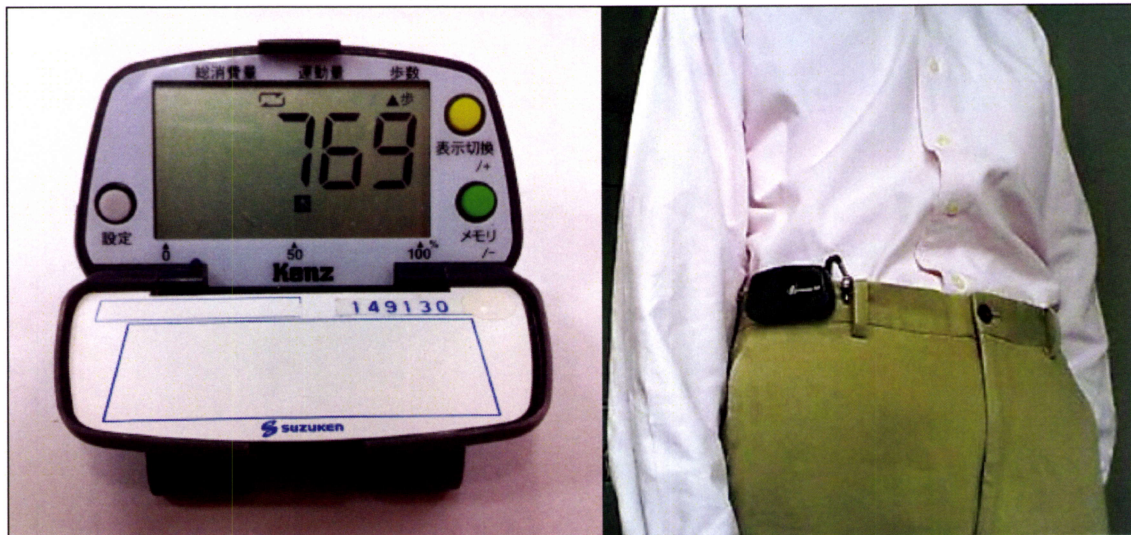
Photo 2-1. 本研究で用いた加速度計測装置付歩数計（Life Coder Ex, Suzuken Co., Ltd., Nagoya, Japan）本体（左写真）及び装着例（右写真）。本研究で用いた加速度計測装置付歩数計は右の写真のように、腰の部分に装着するものであった。
