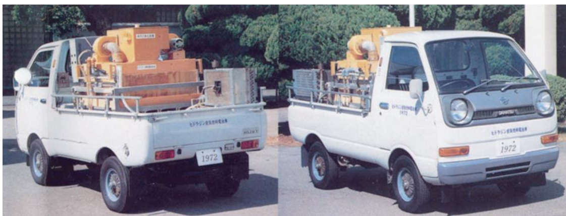
Fig. 2.1 水加ヒドラジンを燃料とするアルカリ燃料電池自動車
