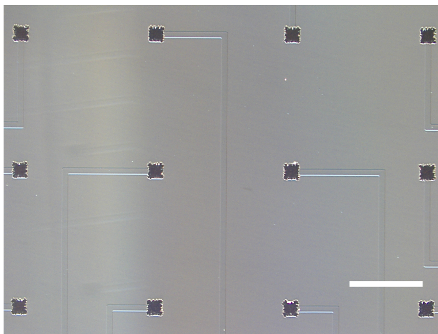
図 2.6 MED プローブ底面の微小平面電極の微分干渉顕微鏡像. スケールバーは 200 \mu\text{m} .
