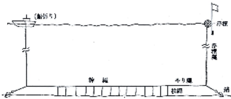
延縄（底延縄）の模式図（金田，2005）
