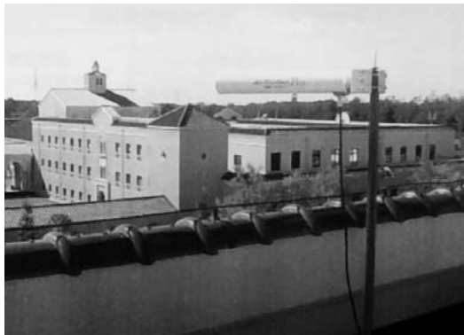
図1 屋外無線LAN接続実験(2.4GHzWi-Fi用指向性アンテナ(技適製品)使用)
