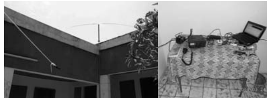
図13 GAOUA市内ホテルの一角に設置したマルチバンドダイポールおよび進行波ワイヤーアンテナ(左)と使用したHFトランシーバとパソコン(右)
