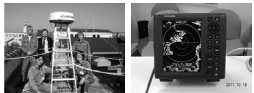
図4 3号館屋上に設置された古野電気船舶用レーダー(左)と受信画面(右)
