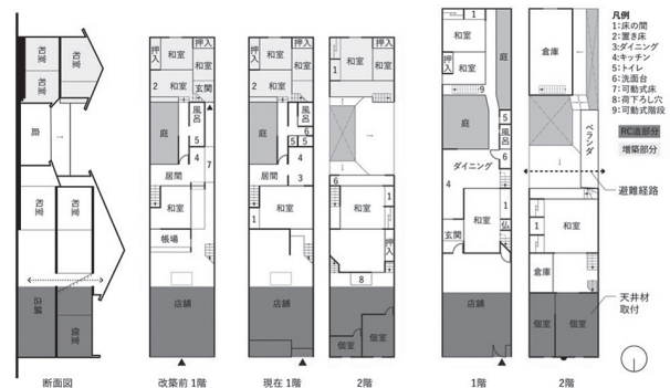
図14 聞き取り調査から描いた11軒長屋の東から3番目の家(A/図の左)の断面図と平面図と、2番目の家(B/図の右)の平面図
