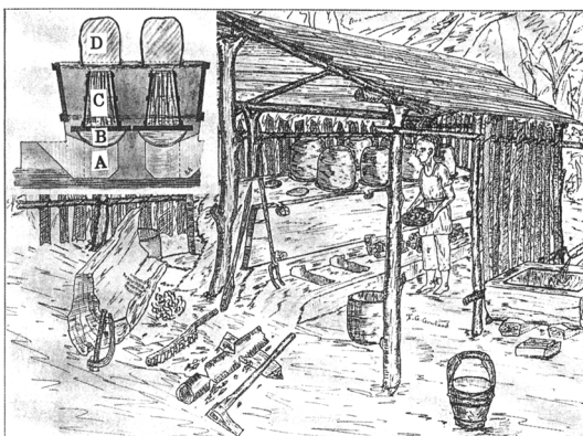
図3 樟脳蒸留装置
